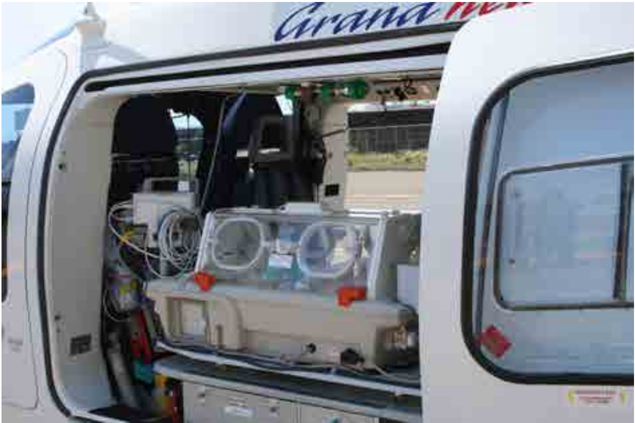
保育器の背面側。窓が反対側にもあり、機内に収容した状態でも両側から処置が可能。 保育器の右下部に AC/DC コンバーター。
