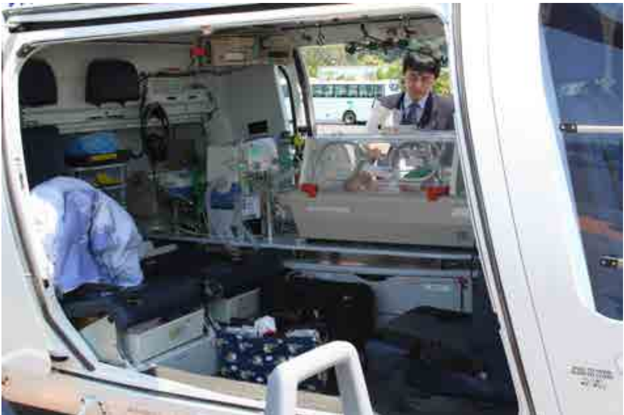
保育器の背面側。窓が反対側にもあり、機内に収容した状態でも両側から処置が可能。 保育器の右下部に AC/DC コンバーター。
