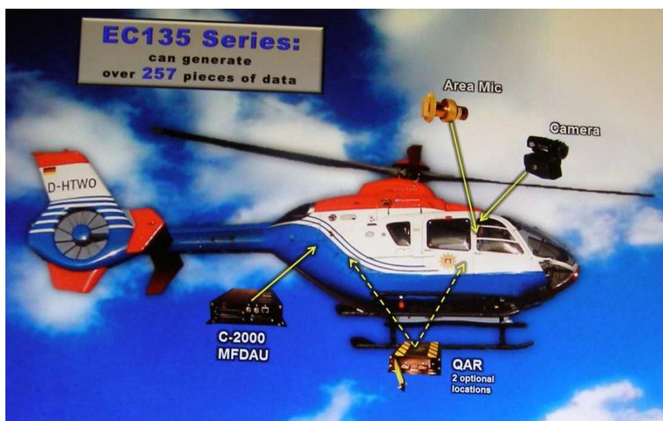
上図に見る通り、C-2000 多機能データ取得装置 (MFDAU : Multi Function Data Acquisition Unit) は機内後部に取り付ける。また記録装置 (QAR : Quick Access Recorder) は主キャビン前方か後方に取り付け、容易に取り外してビデオや音声を再生することができる。またエンジンや機体のデータを記録するための SD カード (Super Density Card) も内蔵していて、そこから飛行状況を再現することもできる。そしてコクピット天井部にカメラと集音マイクがつく。
