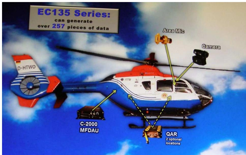
上図に見る通り、C-2000 多機能データ取得装置 (MFDAU : Multi Function Data Acquisition Unit) は機内後部に取り付ける。また記録装置 (QAR : Quick Access Recorder) は主キャビン前方か後方に取りつけ、容易に取り外してビデオや音声を再生することができる。またエンジンや機体のデータを記録するための SD カード (Super Density Card) も内蔵していて、そこから飛行状況を再現することもできる。そしてコクピット天井部にカメラと集音マイクがつく。
